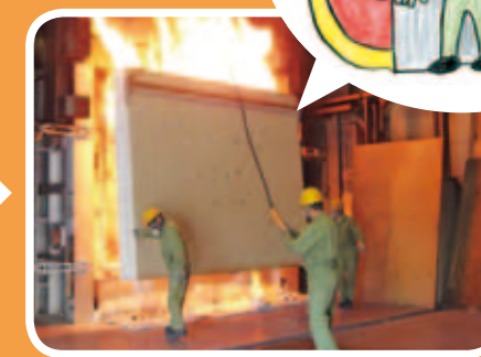
800℃ 45分過熱後、炉より搬出板は勢いよく炎を上げているが、内壁側の石こうボードに異常はみられない。
